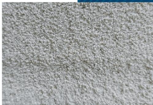
**Aperçu des microbilles de verre expansé recyclé dans l'enduit**
