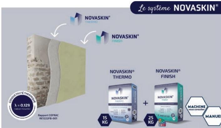
Son application à la machine s'effectue par passes de 3 à 5 cm dès raffermissement de la passe précédente jusqu'à une épaisseur finale maximale de 10 cm et arrêté à 15 cm du sol fini. Le temps de séchage à respecter est de 7 jours minimum.
