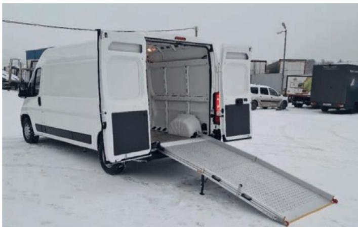
de passage 1000 Kg – Rampe posée au sol avec pied de soutien – Toutes les rampes de la gamme DH-AI 1000 Kg sont équipées d'un pied de soutien – ©Dhollandia
