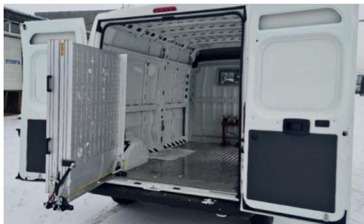
Dhollandia Gamme DH AI fixe/repliable – Rampe avec pied pivotant permettant de conserver l'espace et d'accéder à la caisse du véhicule sans déployer la rampe © Dhollandia
