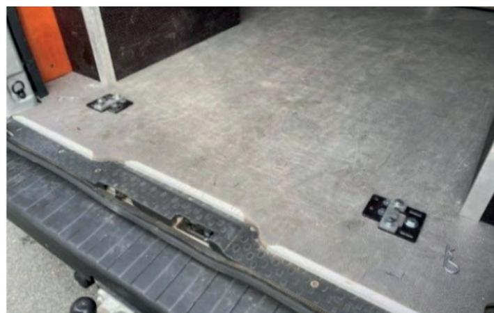
Dhollandia Gamme DH AI – Rampe équipée d'un système de montage et de démontage rapide maximisant la flexibilité du véhicule ©Dhollandia
