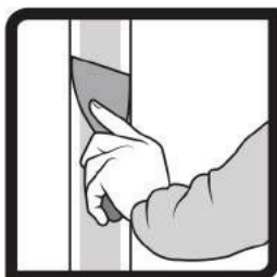
Application de la bande HP SEMIN au couteau
